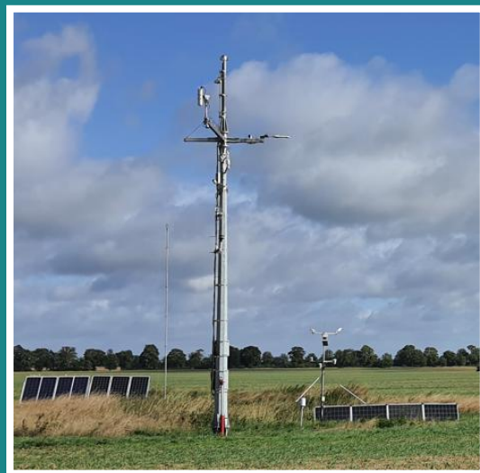
Abb. 1: Eddy-Kovarianz-Messturm und Klimastation auf einem Feld bei Heydenhof, Mecklenburg-Vorpommern. Am Turm sind die für die Erfassung des Gasaustauschs notwendigen Instrumente installiert.
